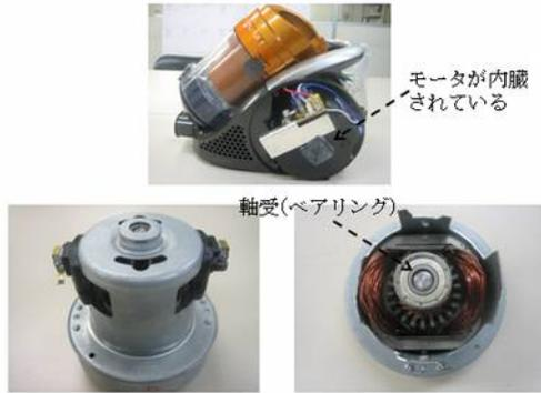
図4 掃除機のモーターの軸受
