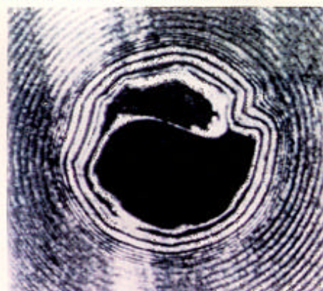
写真 5 輪切りにされた巻芯部（ショート前）：巻芯の右上に“くの字”に曲がった部分がある
